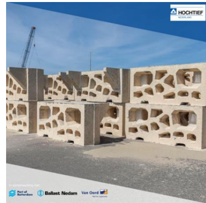
E-concrete blokken om de biodiversiteit te bevorderen
